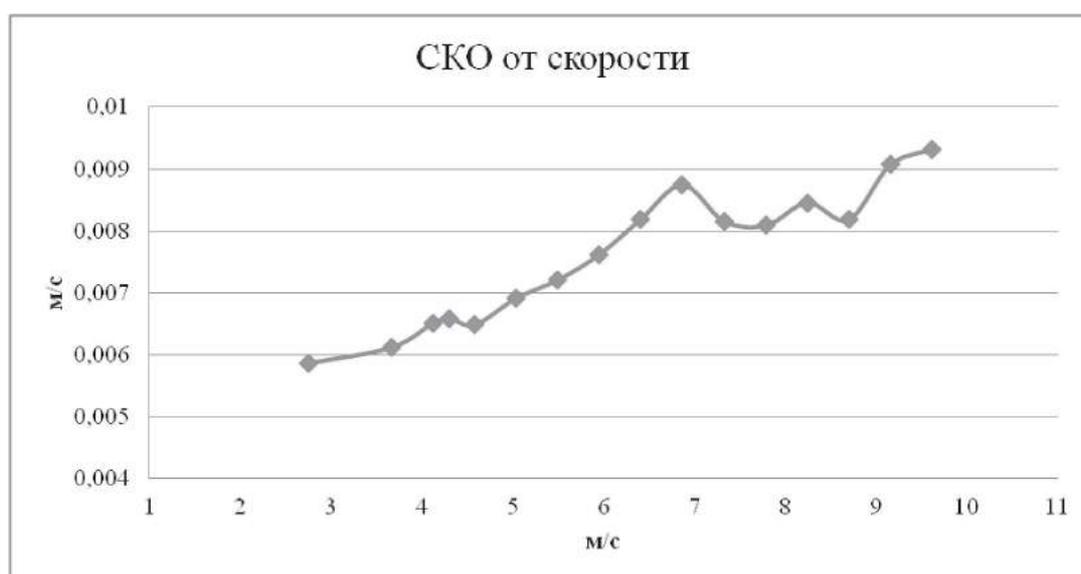
Рис. 2. График зависимости СКО измерения скорости от скорости
