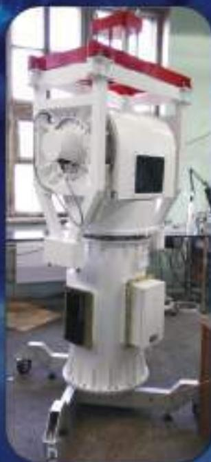
ОПУ для стационарной антенной установки с зеркалом
