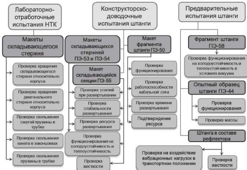
Рис. 8. Схема комплекса испытаний
