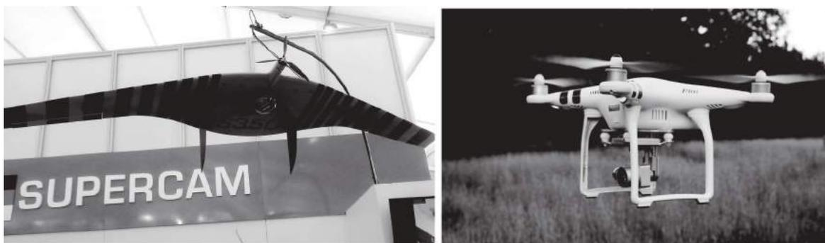
Рис. 1. БЛА «Supercam» самолетного типа (слева) и БЛА вертолетного типа (справа – квадрокоптер DJI Phantom)
