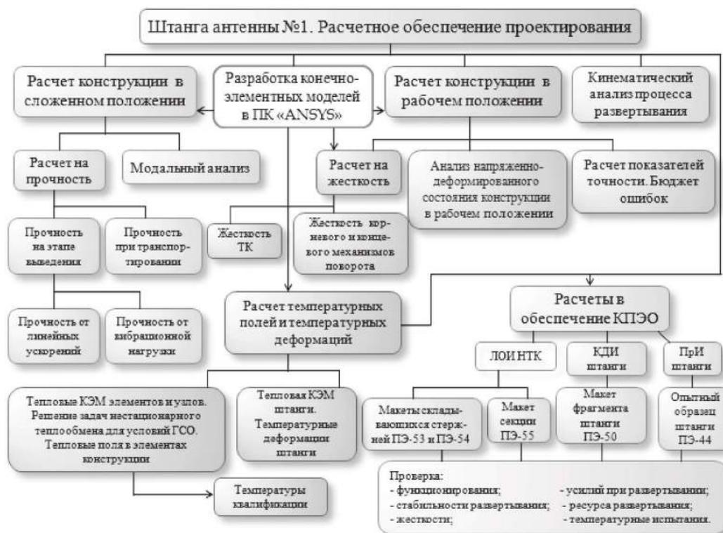
Рис. 4. Схема расчетного обеспечения проектирования
