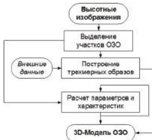
Рис. 1. Общая блок-схема 3D-моделирования ОЗО
