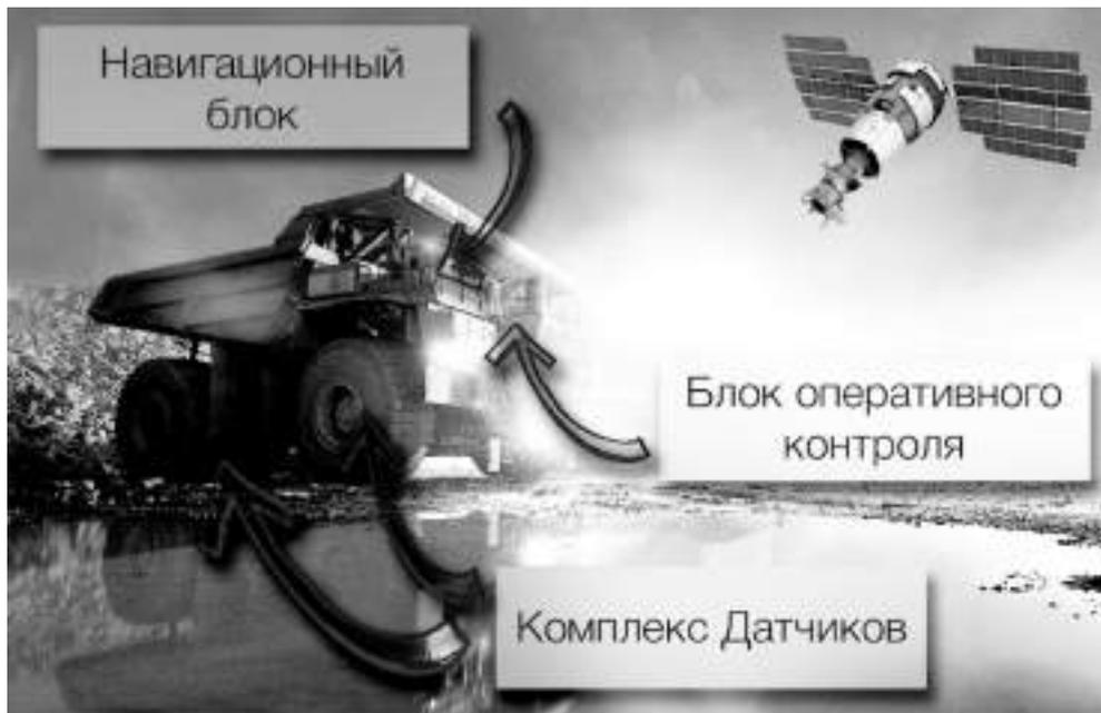
Рис. 2. Типовой набор бортового оборудования мобильных объектов системы управления ГТК
