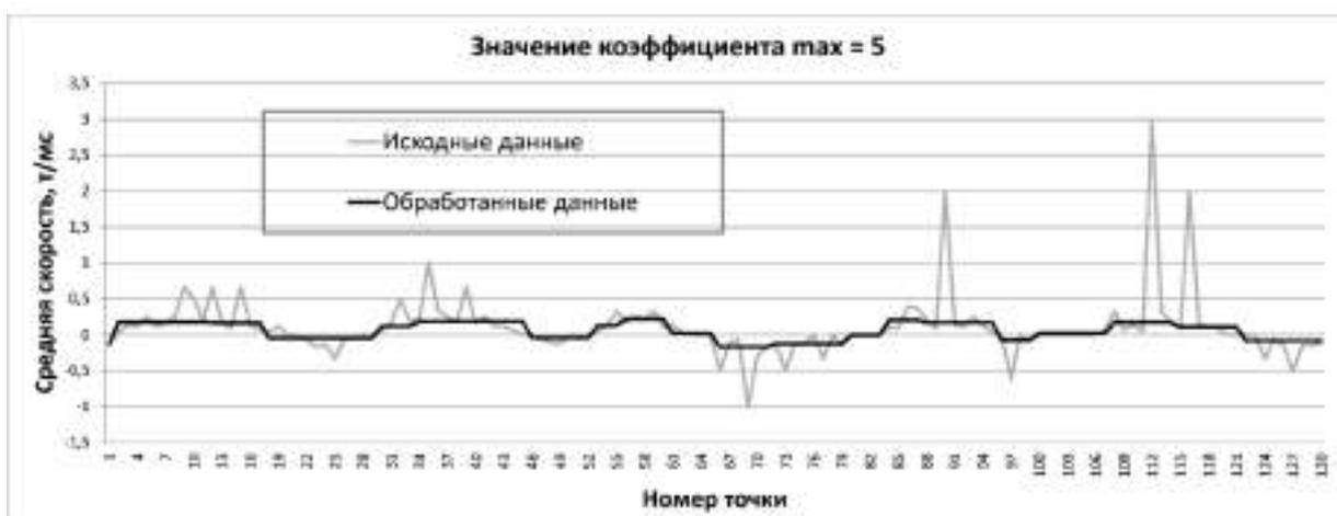
Рис. 2. График изменения горизонтальной скорости пера при коэффициенте  $max=5$
