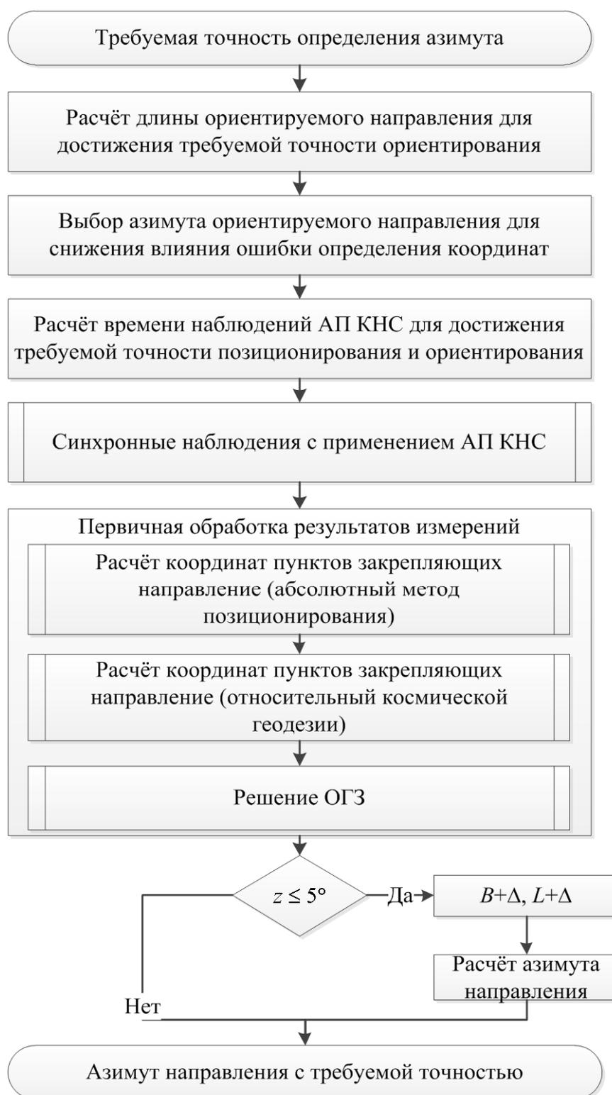
Рис. 4. Методика применения АП КНС для автономного определения азимуты с требуемой точностью
