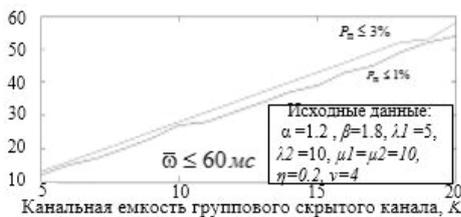
Рис. 12. Зависимость допустимого числа источников трафика  $Z$  от канальной емкости группового скрытого канала  $K$
