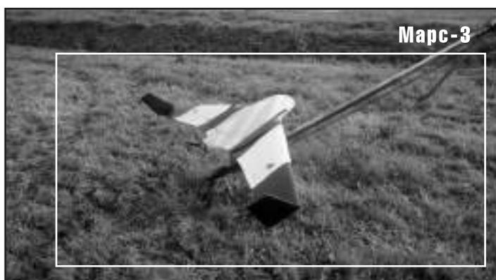
Конструкцией беспилотного летательного аппарата «Марс-3» является летающее крыло — идеальная платформа для переноса большой полезной нагрузки, обладающее высокой выносливостью.
